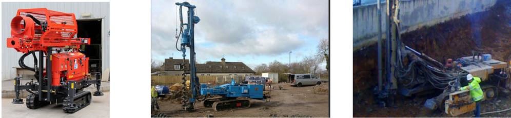
Figure 19 Typical mini piling rigs
